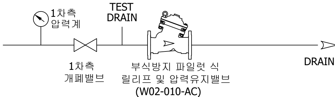
그림 2 부식방지 파일럿 식 릴리프 및 압력유지밸브(W02-010-AC)의 설치 예시도
