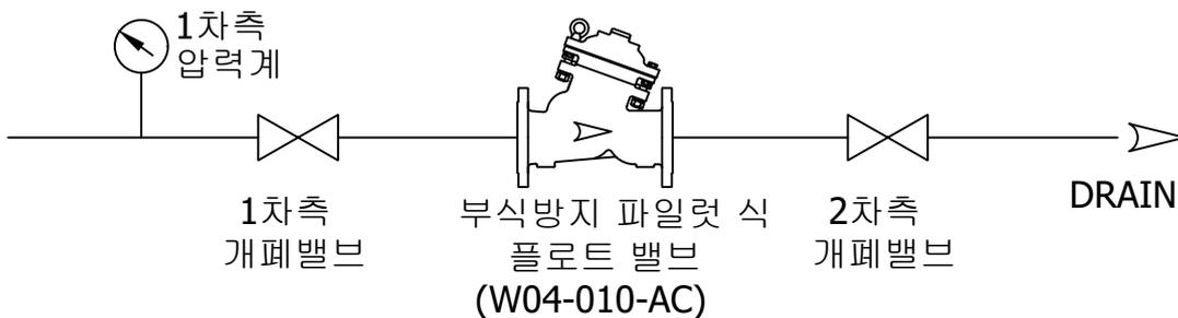
그림 2 부식방지 파일럿 식 플로트 밸브(W04-010-AC)의 설치 예시도
