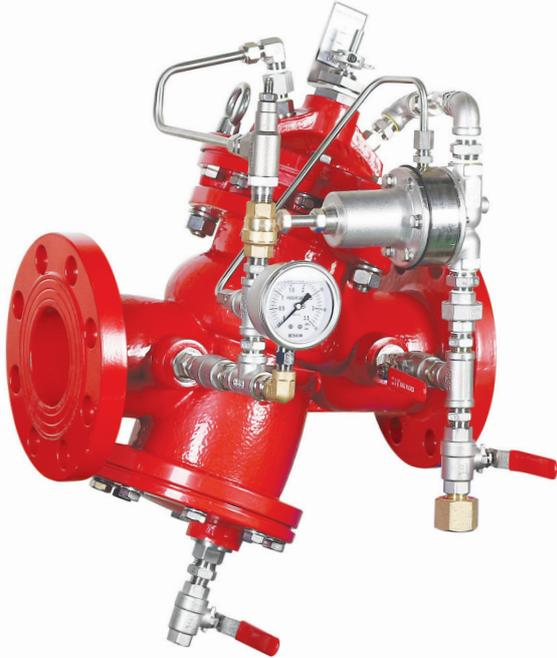
모델 W02-050-MFA AC 밸브는 복합 및 부식 방지 구조를 포함하여, 밸브 자체 부식 발생을 방지하며, 소방 시스템 관로내에서 설정 압력보다 과도한 압력이 발생시 이를 해소시켜 시스템을 보호하는 릴리프 기능과 일렬 배관에 있어서 유출측(2차측) 유량의 변동 또는 압력의 변화에 관계없이 유입측(1차측)의 설정된 압력으로 자동적이고 안정적으로 일정하게 유지하는 기능이 있으며 이때 설정된 압력을 초과하는 유량만 흘러 보내도록 합니다.
