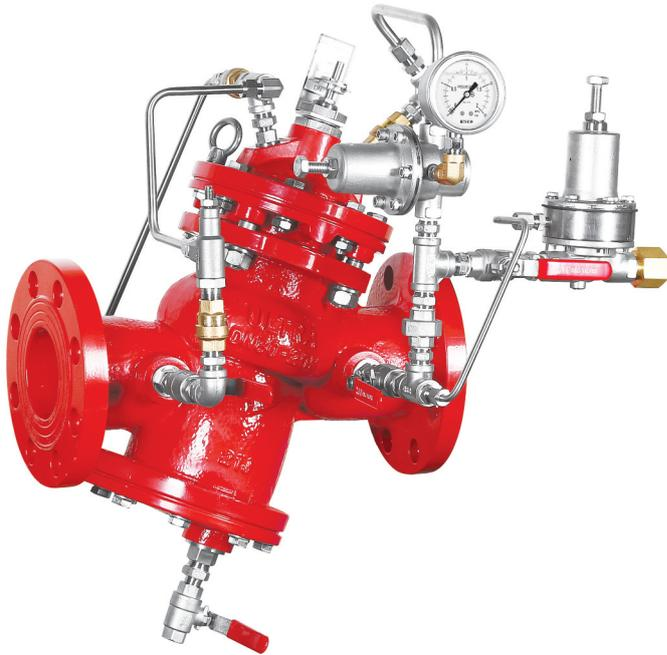
모델 W01-060-MFA-AC 밸브는 복합 및 부식 방지 구조를 포함하여, 밸브 자체 부식 발생을 방지하며, 평소 밸브는 차단 상태로 유출측(2차측) 설정 압력을 유지하며, 소화 시 소방 용수 공급라인의 높은 압력을 유량의 변동 또는 압력의 변화에 관계없이 유출측(2차측)의 설정된 압력으로 자동적이고 안정적으로 일정하게 유지시켜 줍니다.
