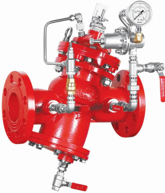
모델 W01-010-MFA-AC 밸브는 복합 및 부식 방지 구조를 포함하여, 밸브 자체 부식 발생을 방지하고, 유입측(1차측) 높은 압력을 유량, 압력의 변화에 관계없이 유출측(2차측)을 설정된 낮은 압력으로 자동적이고 안정적으로 일정하게 유지합니다.
